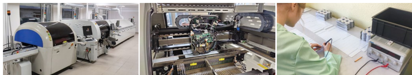
Линия поверхностного монтажа компонентов
